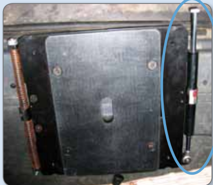
Siège à suspension horizontale celle-ci pouvant être activée ou désactivée.
