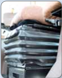
Siège à suspension pneumatique pouvant s'adapter au poids et à la taille du conducteur.
